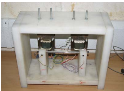
شکل ۳ سیستم تعلیق فعال مغناطیسی
