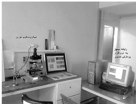
شکل ۳ میکروسکوپ نوری برای اندازه‌گیری طول درگیری ابزار و براده به همراه کامپیوتر مجهز به نرم‌افزار پردازش تصویر
