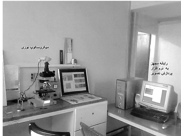
شکل ۳ میکروسکوپ نوری برای اندازه‌گیری طول درگیری ابزار و براده به همراه کامپیوتر مجهز به نرم‌افزار پردازش تصویر
