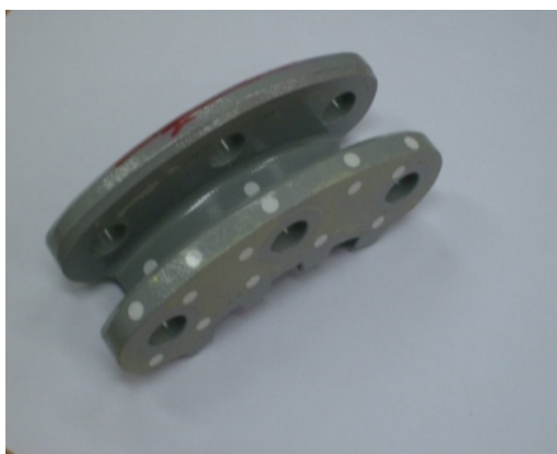
شکل ۸ قطعه پس از فرایند پوشش‌دهی الکتریکی
