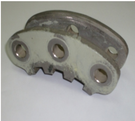
شکل ۷ نمایی از قطعه اتصال دهنده بین بال و بدنه هواپیما
