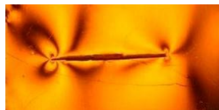
ب- باز شدن لبه‌های شکاف پس از بازپخت
