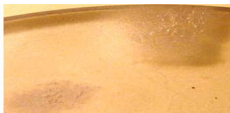
شکل ۱۱ نمونه‌ای از آسیب‌های سطحی پس از بازپخت
