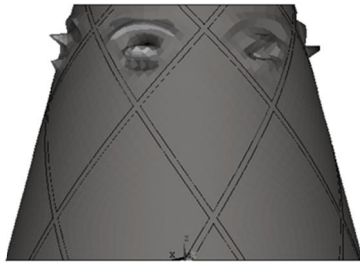
شکل 7 کمانش موضعی در پوسته خارجی
