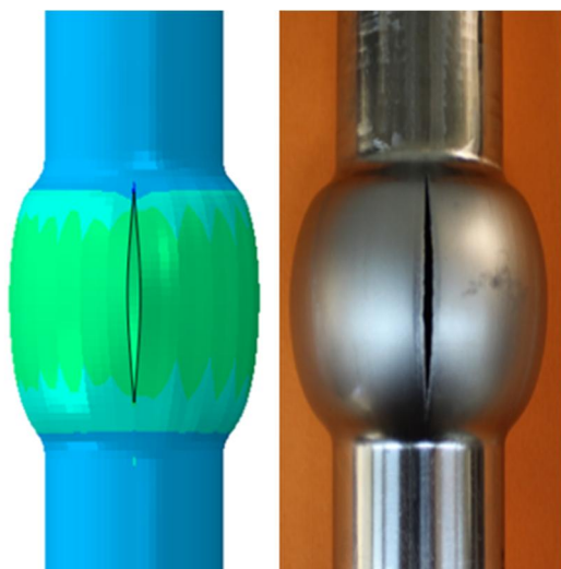
شکل 21 مقایسه ترکیدگی لوله با روش RPF در آزمون T7 (الف) آزمون تجربی، (ب) شبیه‌سازی
