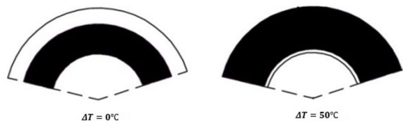
شکل 9 تغییرات منطقه پلاستیک در گرادیان‌های حرارتی مختلف ( m_1, m_2, m_3, m_4 ) = (-2.9, -2.9, -2.9, -3.4)
