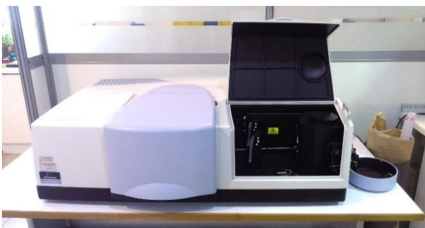
شکل 1 دستگاه اسپکتروفوتومتر برای اندازه‌گیری خواص تشعشعی شیشه‌ها (واقع در بخش انرژی مرکز تحقیقات راه، مسکن و شهرسازی)
