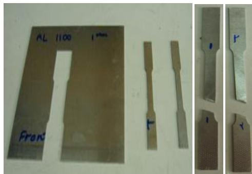
شکل ۳ نمایی از نمونه‌های تهیه شده از ورق آلومنیومی برای انجام آزمایش کشش قبل و بعد از آزمایش
