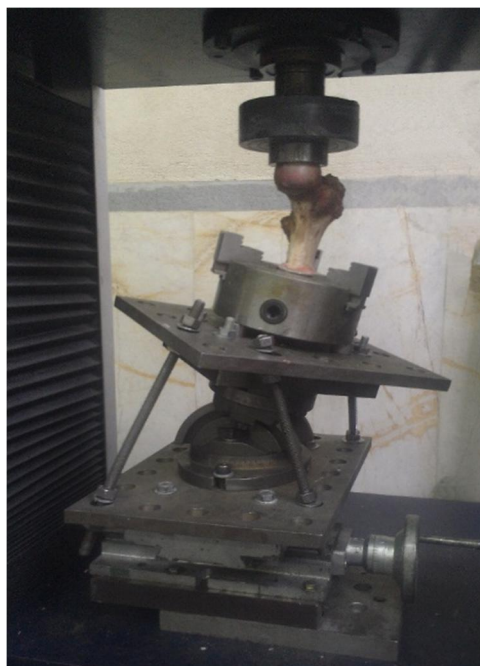
شکل 3 نمونه استخوان ران مقید شده در فیکسچر و تحت شرایط بارگذاری در دستگاه تست کشش-فشار
