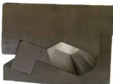
Fig. 6 The three-piece liquid impact forming die شکل 6 قالب شکل‌دهی با ضربه مایع متشکل از سه قطعه
