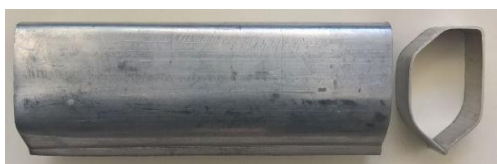
Fig. 17 The test result for aluminium tube filled with water شکل 17 شکل حاصل از آزمایش مربوط به لوله آلومینیومی با آب
