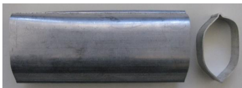
Fig. 16 The test result for aluminium tube without filling it with liquid شکل 16 آزمایش مربوط به لوله آلومینیومی بدون پر کردن لوله از سیال
