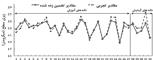
شکل ۳ مقایسه‌ی بین نتایج تجربی و نتایج خروجی از شبکه‌ی عصبی. الف. پهنای برش ب. انحراف برش ج. زبری سطح
