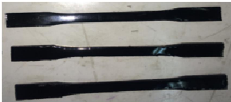
Fig.1 Specimen of without fiber in different percentages of carbon nanotube شکل 1 نمونه بدون الیاف در درصدهای مختلف نانو لوله‌ای کربنی
