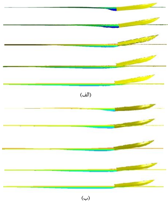
شکل ۱۲ جریان ایجاد شده در پشت شناور از نمای جانبی، (الف) شناور اصلی، (ب) شناور تونل‌دار (برای ۵ سرعت ۱۰، ۱۵، ۲۰، ۲۵ و ۳۰ متر بر ثانیه به ترتیب از بالا به پایین)
