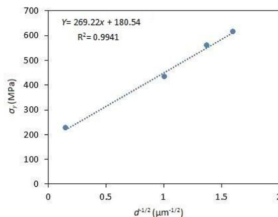
شکل 9 رابطه بین اندازه دانه و استحکام تسلیم (هال-پچ) تیتانیم CP فرآوری شده به وسیله MDF در دمای محیط
