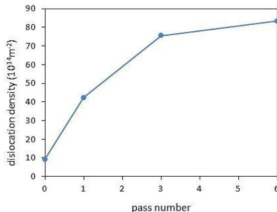
شکل 10 دانسیته نابهایی‌های محاسبه شده با استفاده از روابط، برای نمونه‌های
