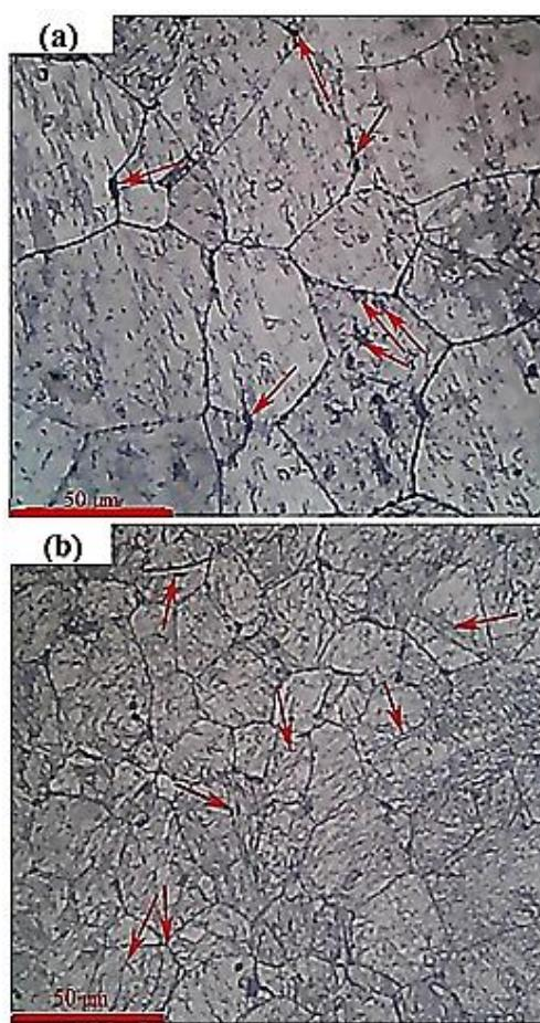
**شکل 5** تصاویر میکروسکوپ نوری تیتانیم CP، الف- آنیل شده و ب- 1 پاس MDF شده در دمای محیط
