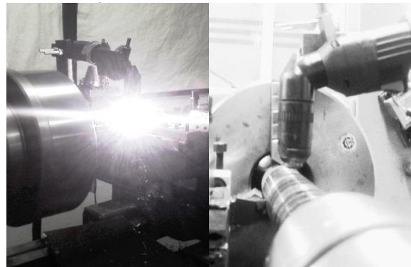
شکل 8 انجام تراش کاری به کمک پلاسمای
