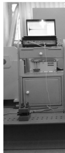
شکل 9 استخراج پاسخ ارتعاشی تیر فولادی با شتاب‌سنج پیزوالکتریک Type4507 شرکت B&K و دستگاه داده‌برداری چهار کاناله Type 3109
