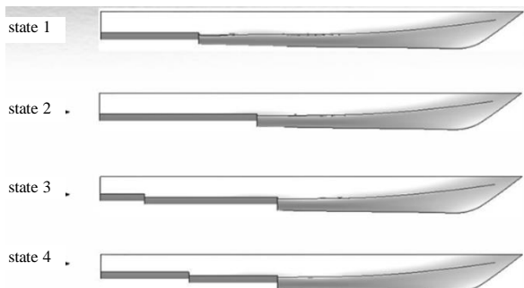
Fig. 11 Side view of planning hulls with steps شکل 11 نمای از جانب شناورها با اعمال پله
