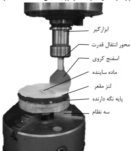
شکل 10 فرایند پرداخت با ابزار کروی
