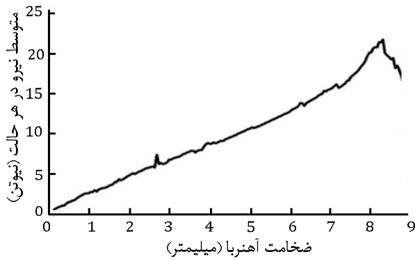
شکل 9 تاثیر تغییر ضخامت آهن‌ربا ( \tau_p ) در نیروی میراگر (در 18 میلی‌متر)
