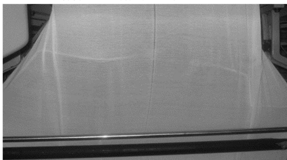
شکل 6 اعمال عیب چهار سوزن شکسته در پارچه
