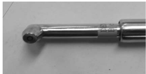
شکل ۳ پروب خازنی مورد استفاده در اندازه‌گیری (ساخت شرکت ژاپنی ADE Micro Sense)
