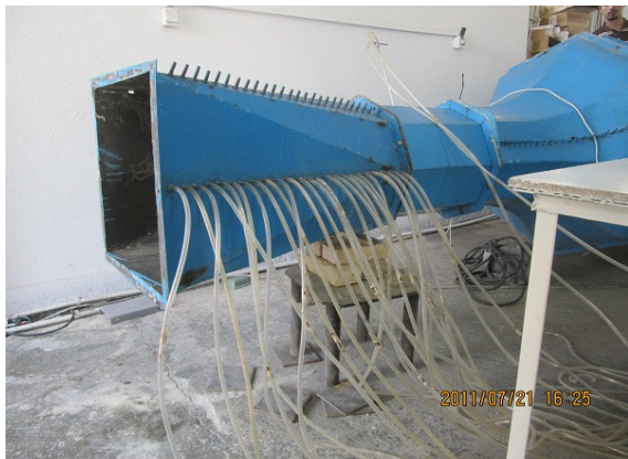
شکل ۴ اتصال شلنگ‌ها به سوراخ‌های فشار در دیفیوزر
