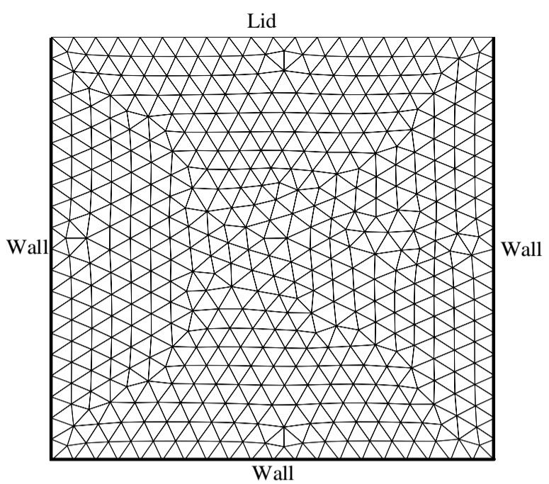
شکل 9 شبکه تولید شده در هندسه مربعی به صورت
