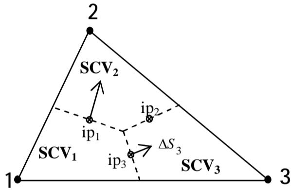
شکل 1 تعریف زیرمجموعه‌ها و بردارهای سطحی در المان
