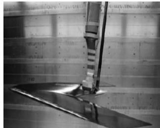
شکل ۴ نحوه قرارگیری بال مثلثی الماسی در تونل باد [7]
