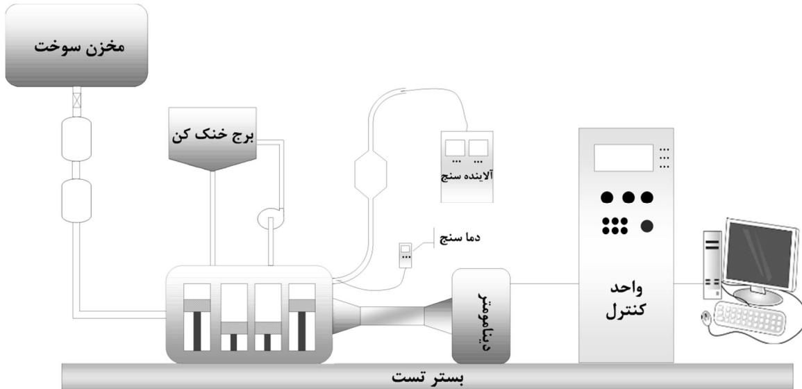
شکل ۱ نمایی شماتیک از تجهیزات آزمایش موتور
