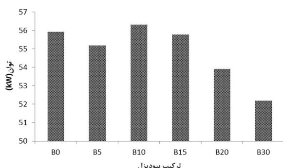
شکل 2 توان موتور در ترکیبات مختلف بیودیزل- دیزل
