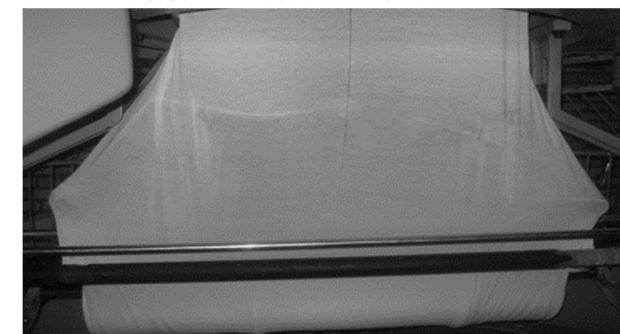
شکل 5 اعمال عیوب دو سوزن شکسته در پارچه
