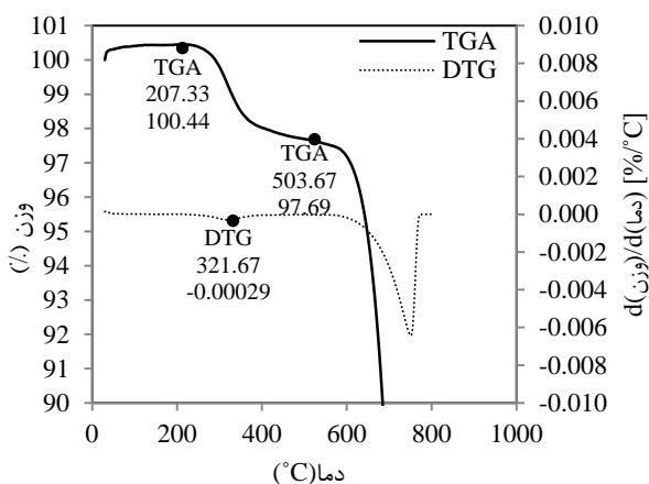
شکل ۲ منحنی‌های DTG و TGA نانوذرات کربنات کلسیم اولیه خریداری شده از کارخانه
