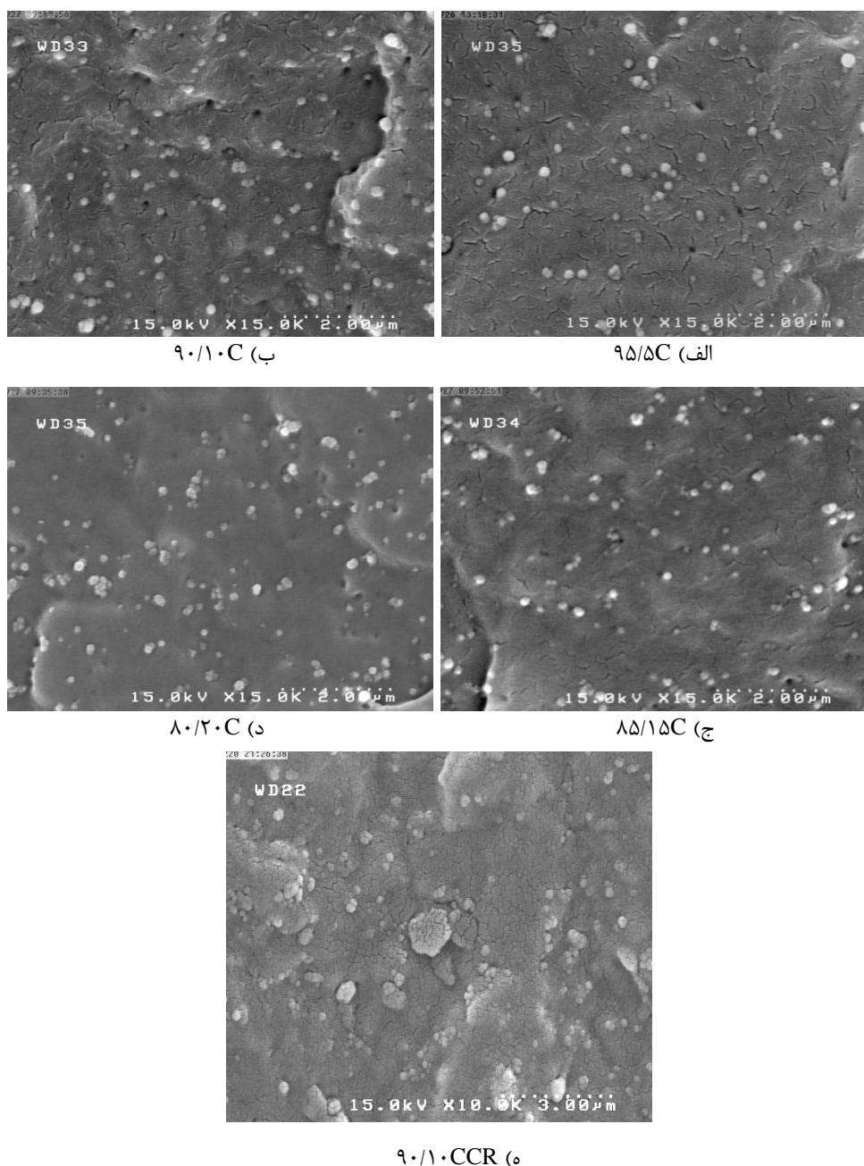
شکل ۵ تصاویر FESEM گرفته شده از سطوح شکسته شده با نیتروژن مایع نانوکامپوزیت‌های پر شده با نانوذرات کربنات کلسیم
