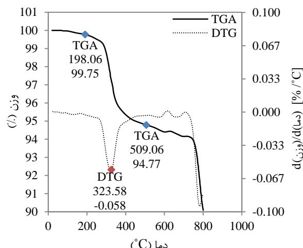
شکل ۳ منحنی‌های DTG و TGA نانوذرات کربنات کلسیم پس از روکش دهی تک لایه کامل با اسید استئاریک
