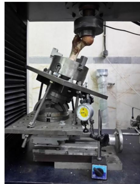
شکل 3 نمایی از فیکسچر در حین انجام آزمون فشار در زوایای بارگذاری مشخص
