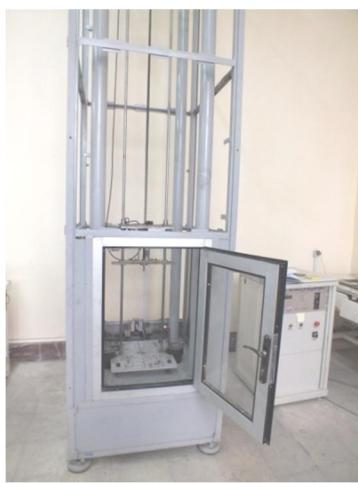
شکل 10 دستگاه آزمون سقوط وزنه
