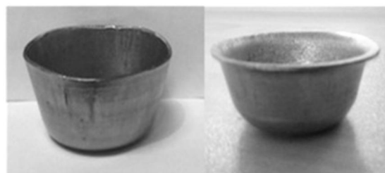
شکل 4 قطعه مخروطی ساخته شده از جنس فولاد St14 الف - فرآیند ساچمه‌ای ب - فرآیند کشش عمیق سنتی
