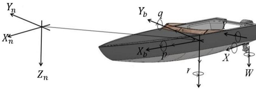
شکل 1 مختصات ثابت و مختصات متحرک در حرکت شناور
