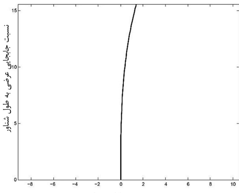
شکل 10 جهت حرکت شناور با زاویه سکان 15 درجه
