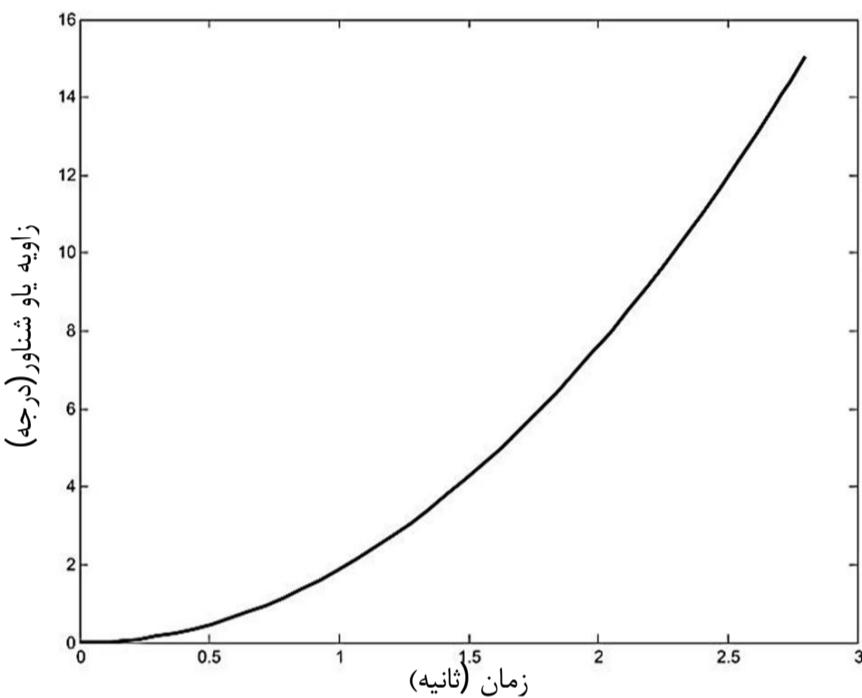
شکل 11 زاویه یاو شناور در زاویه سکان 15 درجه
