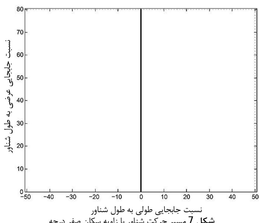
شکل 7 مسیر حرکت شناور با زاویه سکان صفر درجه
