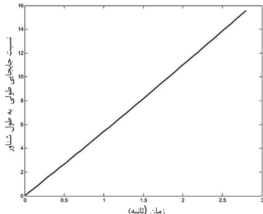
شکل 12 جابجایی شناور در راستای حرکت سرچ با زاویه سکان 15 درجه
