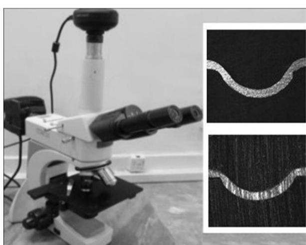
شکل 6 اندازه‌گیری میکروسکوپی مقاطع در بررسی پروفیل پرشدگی
