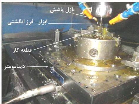
شکل 3 نمایی از چگونگی چیدمان و سایل آزمایش
