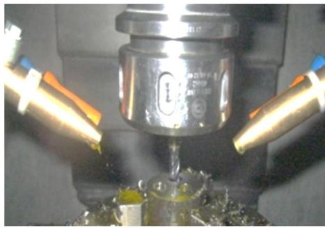
شکل 4 نمایی از آزمایش‌های فرزکاری مارپیچ
