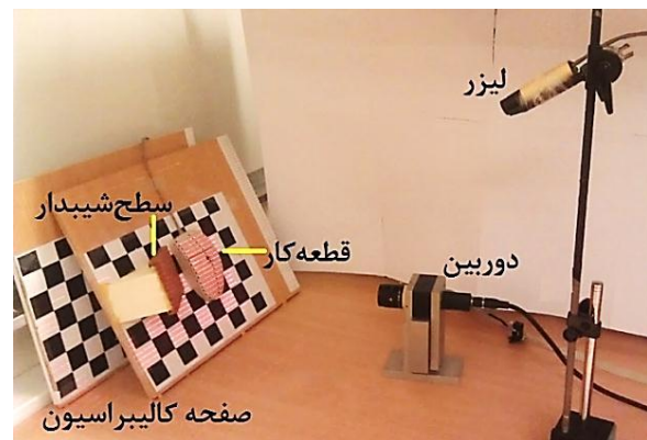
شکل ۷ اجزای سخت‌افزاري اسکنر ليزري
