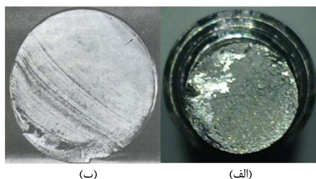
شکل ۴ الف- مقطع شکست نمونه ب- مقطع استاندارد شکست خستگی مشاهده مقطع شکست نمونه آزمایش در شکل ۴- الف به خوبی شروع و گسترش سریع ترک از محلی در سطح (در
