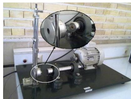
شکل ۲ دستگاه تست خستگی و فک‌های اتصال نمونه
