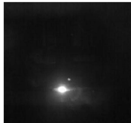
ب) شکل قوس با وجود نانوذرات دی‌اکسید تیتانیوم شکل 17 حالت قوس در فرآیند GMAW
