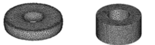
شکل ۷ شبیه‌سازی المان محدود آزمایش فشار حلقه
