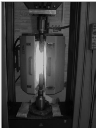
شکل ۴ دستگاه انجام آزمایش فشار و کوره
