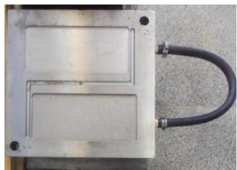
شکل ۲ قالب استفاده شده برای تولید نمونه‌ها
