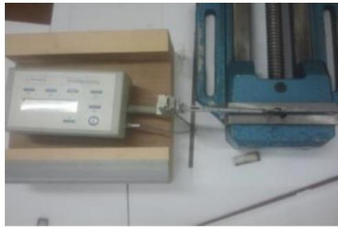
شکل 9 زیر سنج مورد استفاده برای اندازه گیری صافی سطح شیار برش
