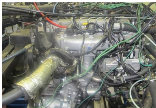
شکل 1 موتور دیزل سواری 1/5 لیتری چهار استوانه خطی سریع 90 کیلووات
