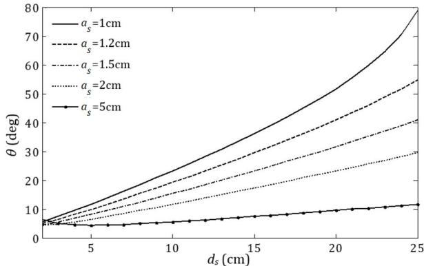
شکل 9 میزان انحراف مکانیزم به عنوان تابعی از فاصله صفحات ایرفویل برای فواصل مختلف سیم از محور دوران در تغییر شکل سوئیپ
