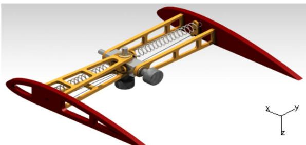
شکل 12 مدل سه بعدی به همراه المان های مختلف در مکانیزم تغییر شکل بال
