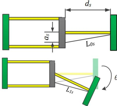
شکل 7 طرح مکانیزم با محرک‌های سیم آلیاز حافظه‌دار در درجه آزادی سوئیپ
