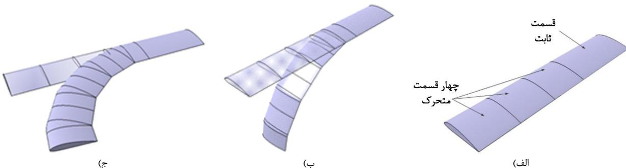
شکل ۱۳ موقعیت قسمت‌های قابل حرکت در بال موردنظر (الف) بال بدون تغییر شکل، (ب) تغییر شکل گال در بال، (ج) تغییر شکل سوئیپ در بال
