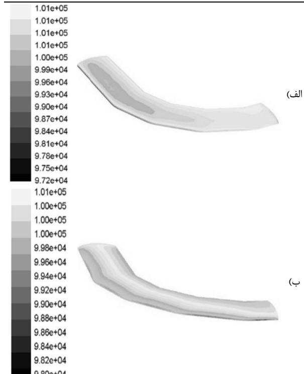
شکل 20 توزیع فشار بر حسب پاسکال روی سطح بال تغییر شکل یافته سوئیپ، (الف) زاویه حمله صفر درجه، (ب) زاویه حمله ۱۵ درجه
