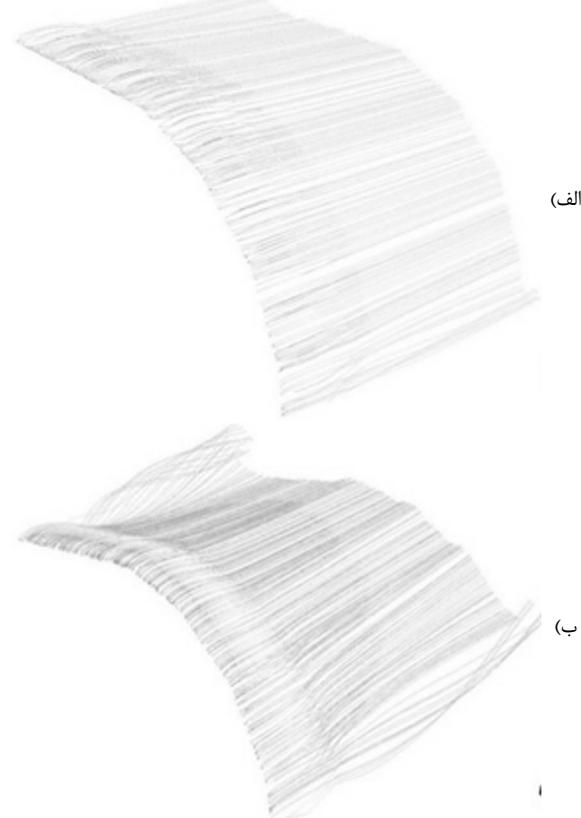
شکل ۱۷ خطوط جریان روی سطح بال تغییر شکل یافته گال، (الف) زاویه حمله صفر درجه، (ب) زاویه حمله ۱۵ درجه
