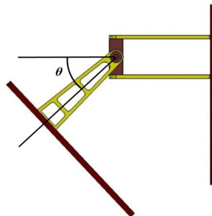
شکل 11 ساختار و نحوه عملکرد مکانیزم طراحی شده در حرکت سوئیپ
