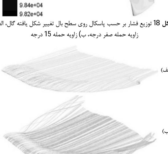
شکل ۱۹ خطوط جریان روی سطح بال تغییر شکل یافته سوئیپ، (الف) زاویه حمله صفر درجه، (ب) زاویه حمله ۱۵ درجه
