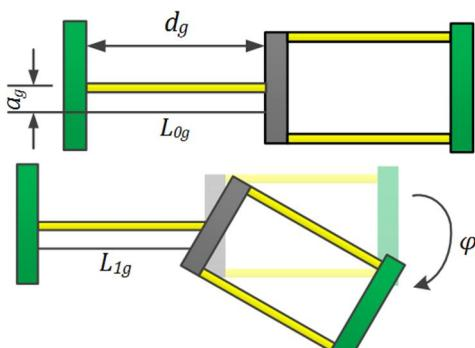
شکل 6 طرح مکانیزم با محرك‌های سیم آلیاز حافظه‌دار در درجه آزادی گال
