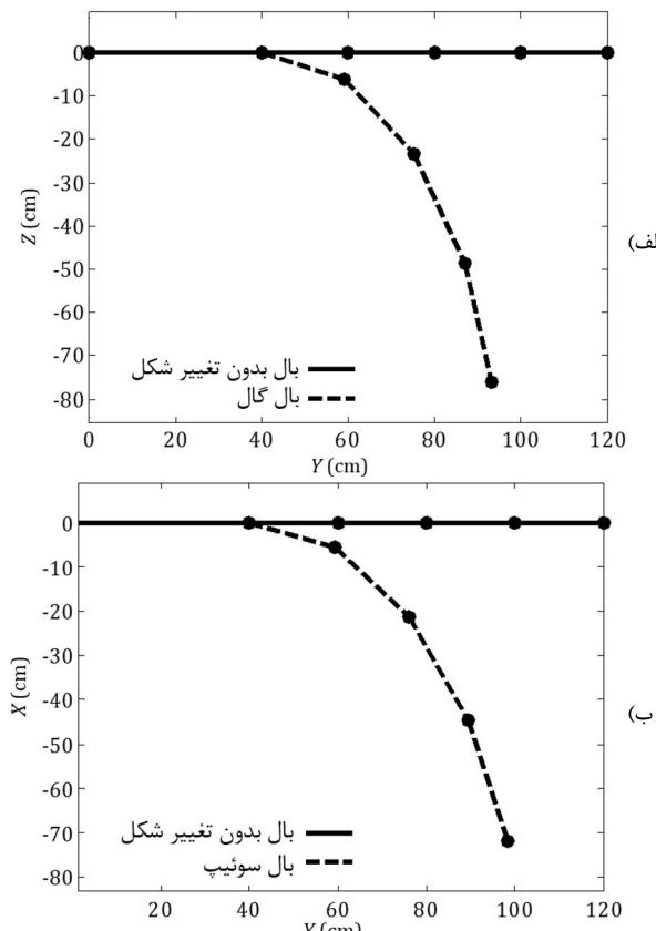
شکل ۱۴ وضعیت‌های اولیه و تغییر شکل یافته. (الف) گال، (ب) سوئیپ
