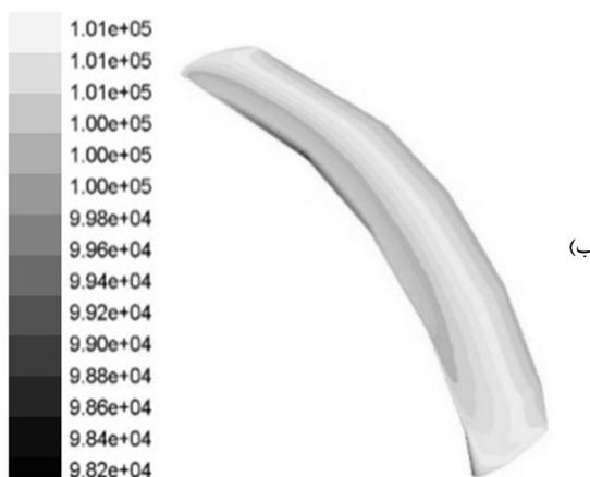
شکل ۱۸ توزیع فشار بر حسب پاسکال روی سطح بال تغییر شکل یافته گال، (الف)
