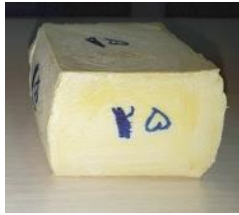
Fig. 7 Polyurethane foam samples under uniaxial compression test شکل 7 نمونه فوم پلی‌اورتان تحت آزمایش فشار تک محور
