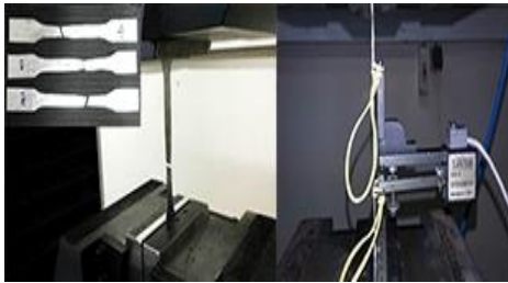
Fig. 1 Steel sheet tensile test
