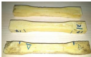
Fig. 9 Polyurethane foam tensile test samples شکل 9 نمونه آزمایش کشش فوم پلی‌اورتان
