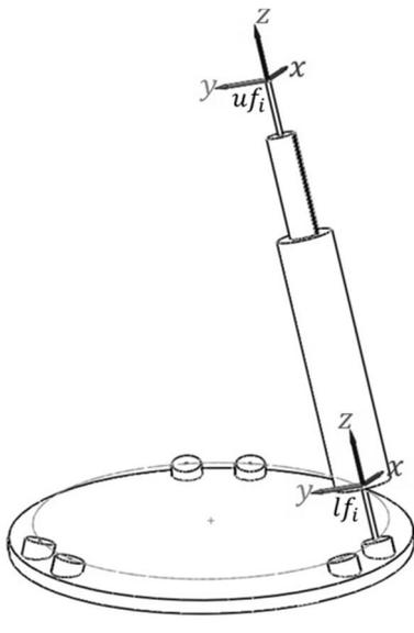
شکل 6 دستگاه های مختصات قرار گرفته بر انتهای بالایی مفصل های خمشی پایه ی اول
