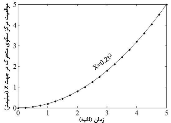
شکل 13 نمودار موقعیت مرکز سکوی متحرک پس از اعمال سرعت به محرکها مطابق شکل 9
