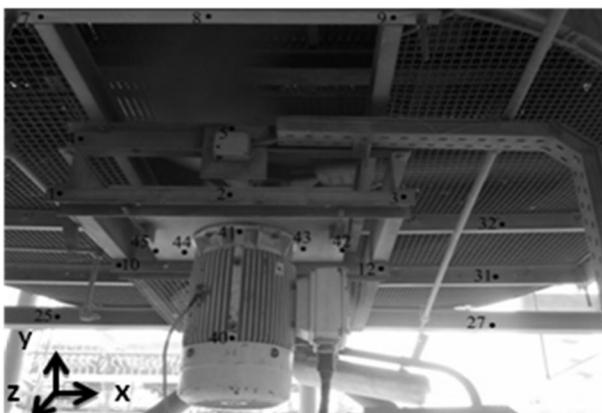
شکل 2 تصویر فن هوایی بهمراه نقاط اندازه گیری
