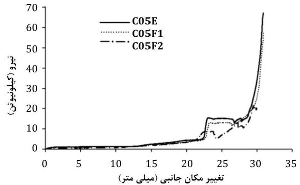
شکل 11 نمودار نیروی جانبی - تغییر مکان سه نمونه آزمایشی با ابعاد هندسی و خصوصیات مادی یکسان و با شرایط پرکنندگی مختلف تحت زاویه بارگذاری 90 درجه
