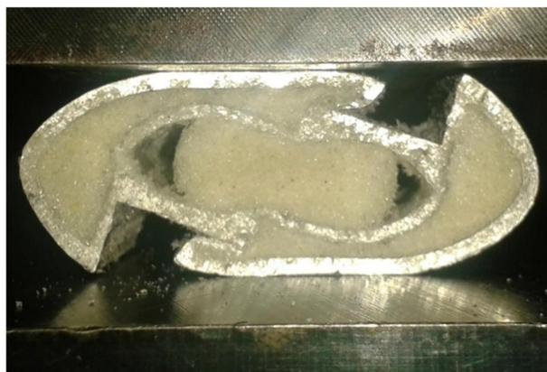
شکل 14 نمونه جدارنازک پر شده از فوم تحت بارگذاری با زاویه 45 درجه، در حین فرآیند پهن‌شدگی جانبی
