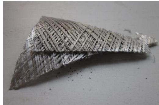
شکل 4 قسمتی از پوسته سوزانده شده جهت تعیین کسر حجمی الیاف در پوسته
