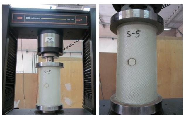
شکل 6 نمونه آمده انجام تست کمانش
