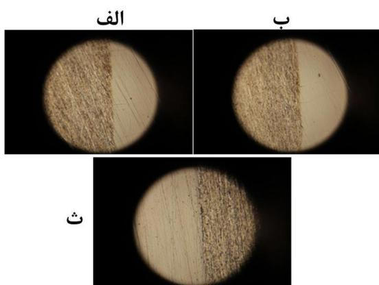
شکل 13 میزان ترکیب بین فلزی برای فولاد و آلومینیوم (کاهش ضخامت ۵۵٪، دمای عملیات حرارتی ۴۰۰ درجه سانتی‌گراد، زمان عملیات حرارتی ۶۰ (الف)، ۱۲۰ (ب) و ۱۸۰ (ث) دقیقه).
