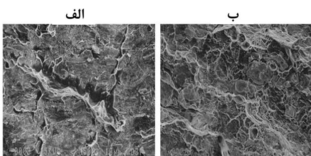
شکل 10 سطوح لایه‌کنی شده برای فولاد (الف) و آلومینیوم (ب) (کاهش ضخامت ۵۵٪، دمای عملیات حرارتی ۴۰۰ درجه سانتی‌گراد و زمان عملیات حرارتی ۱۲۰ دقیقه)
