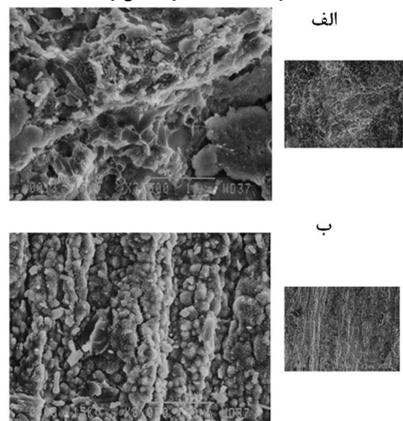
شکل 12 سطح شکست فولاد و آلومینیوم در دمای عملیات حرارتی ۴۷۵ (الف) و ۵۵۰ (ب) درجه سانتی‌گراد
