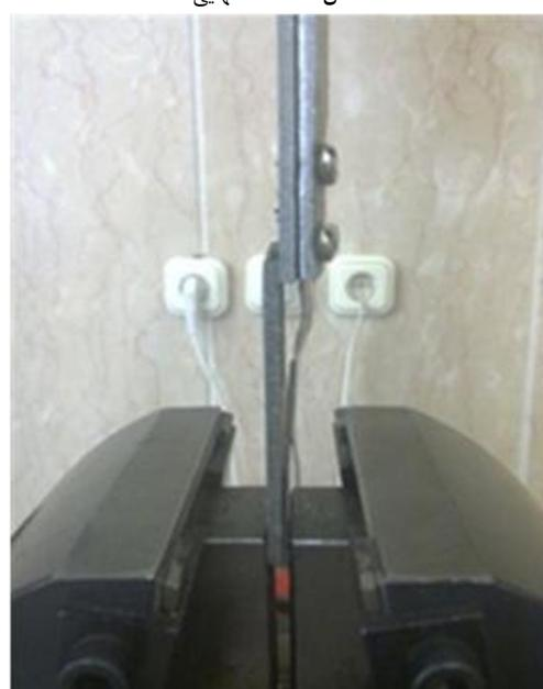
شکل ۴ نحوه انجام آزمایش پوست کنی ۱۸۰ درجه
