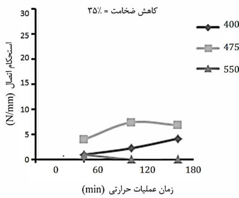
شکل ۵ اثر زمان و دمای عملیات حرارتی بر استحکام اتصال در نسبت کاهش ضخامت %35
