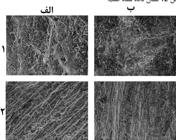
شکل 11 سطوح لایه‌کنی شده فولاد (الف، ۱، الف، ۲) و آلومینیوم (ب، ۱، ب، ۲). (کاهش ضخامت ۵۵٪، زمان عملیات حرارتی ۱۲۰ دقیقه و دمای عملیات حرارتی ۴۷۵، ۱، ب (۱) و ۵۵۰ (الف، ۲، ب (۲) درجه سانتی‌گراد).
