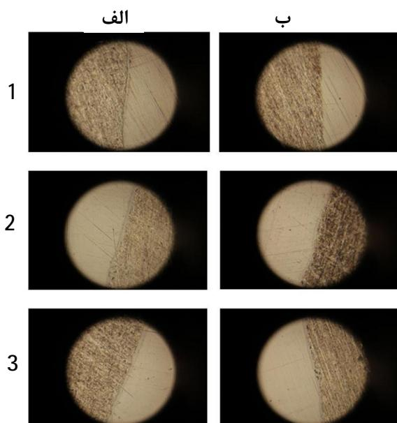
شکل 14 میزان ترکیب بین فلزی برای فولاد و آلومینیوم (کاهش ضخامت ۳۵٪ (الف، ۱)، ۴۵٪ (الف، ۲) و ۵۵٪ (الف، ۳)، دمای عملیات حرارتی ۴۷۵ درجه سانتی‌گراد و زمان عملیات حرارتی ۱۲۰ (الف، ۱، الف، ۲ و الف، ۳) و ۱۸۰ (ب، ۲ و ب، ۳) دقیقه).
