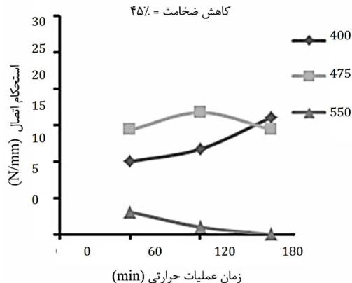
شکل ۶ اثر زمان و دمای عملیات حرارتی بر استحکام اتصال در نسبت کاهش ضخامت %45
