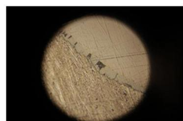
شکل 15 میزان ترکیب بین فلزی برای فولاد و آلومینیوم (درصد کاهش ضخامت (%35)، (الف)، (%45)، (ب) و (%55)، دمای عملیات حرارتی 550 درجه سانتی‌گراد و زمان عملیات حرارتی 180 دقیقه).
