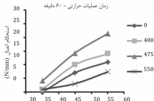
شکل 8 مقایسه استحکام اتصال نمونه بدون عملیات حرارتی با نمونه‌های عملیات حرارتی شده در دماهای مختلف و زمان ۶۰ دقیقه
