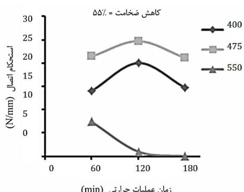
شکل ۷ اثر زمان و دمای عملیات حرارتی بر استحکام اتصال در نسبت کاهش ضخامت %55
