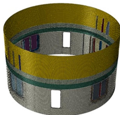
شکل 8 نمای مش بندی شده پوسته تقویت شده
