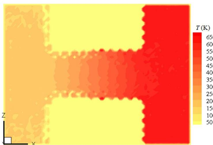
شکل ۲ توزیع دمای سیال برای مخازن بسته در صفحه  $y=0$  وقتی که شعاع مجرای رابط  $11/5$  آنگسترم است.
